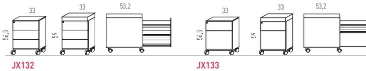
Caisson sur roulettes avec des glissières télescopiques à billes d'acier.
