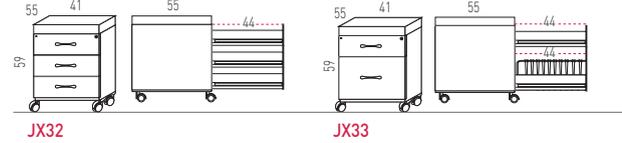
Caissons sur roulettes avec des glissières télescopiques à billes d'acier. Modèle avec et sans coussin sur la partie supérieur
