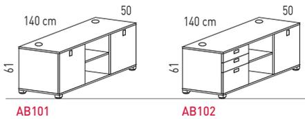
Caisson auxiliaire avec des glissières télescopiques à galets. - hauteur 61 cm
