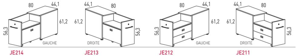
Caisson auxiliaire avec des glissières télescopiques à galets. Tiroir à extraction partielle. - hauteur 113 cm
